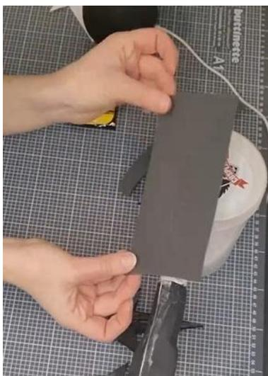
Bevor wir den Stern nun aufkleben, covern wir das PVC-Rohr noch kurz mit 2 mm Foam. Einfach die Maße nehmen (Länge und Umfang) und ein Rechteck aus 2 mm Foam ausschneiden. Das PVC-Rohr mit Kleber einpinseln, sowie eine Seite des Rechtecks. Trocknen lassen. Draufkleben. Hintergrund ist, dass die Farbe auf dem Rohr nicht gut hält und es ist einheitlicher.
